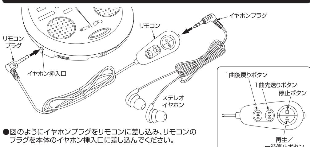
●図のようにイヤホンプラグをリモコンに差し込み、リモコンのプラグを本体のイヤホン挿入口に差し込んでください。
